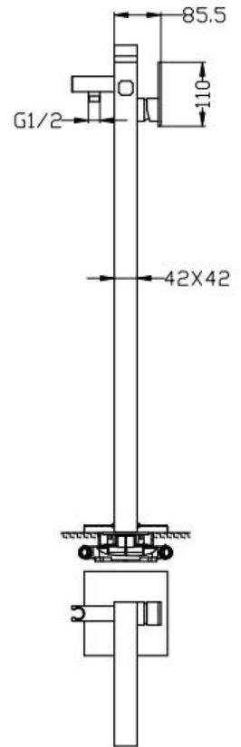
Miscelatore vasca a pavimento completo di base per fissaggio a pavimento, bocca con erogatore, doccia monogetto, flessibile in acciaio lunghezza mm. 1500 attacchi 1/2" G
